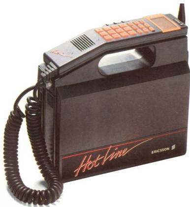
1.2. ábra. Ericsson Hotline 450 Combi: egy saját korában jól hordozhatónak számító NMT-készülék 1989-ből
